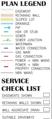
LOCATIONS SHOWN DRAINAGE CONNECTION TYPE 450x450 PIP
